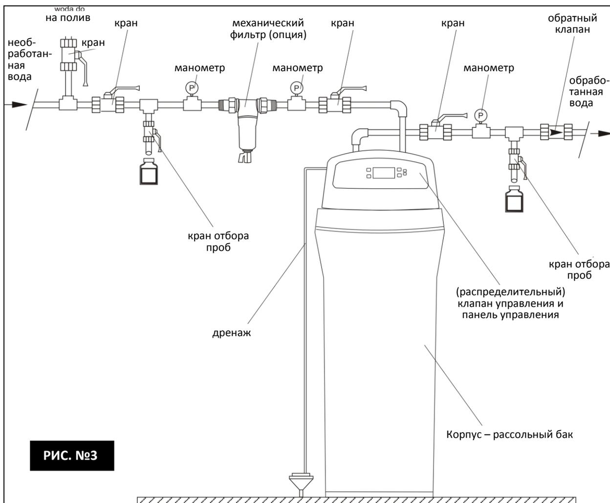
Гидравлическое подключение устройства следует выполнять в соответствии со схемой на РИС. №3. Устройство может поставляться с моноблочным обходным краном (байпасом) с элементами подключения и шлангом для дренажа. Комплектация системы такими элементами как: краны, манометры, фильтр механической очистки и т. д., должна быть выполнена лицом производящим монтаж, так как эти элементы не входят в комплектацию устройства.
